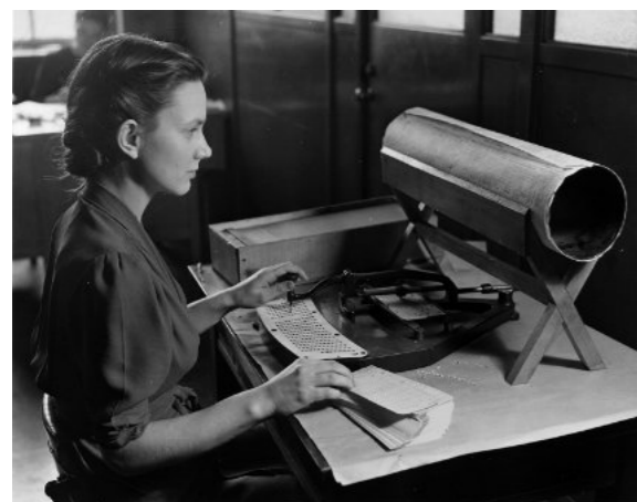
Ryc. 2 Karta perforowana oraz kobieta obsługująca dziurkacz do kart. Źródło: Wikipedia, Punched card, https://en.wikipedia.org/wiki/Punched_card
